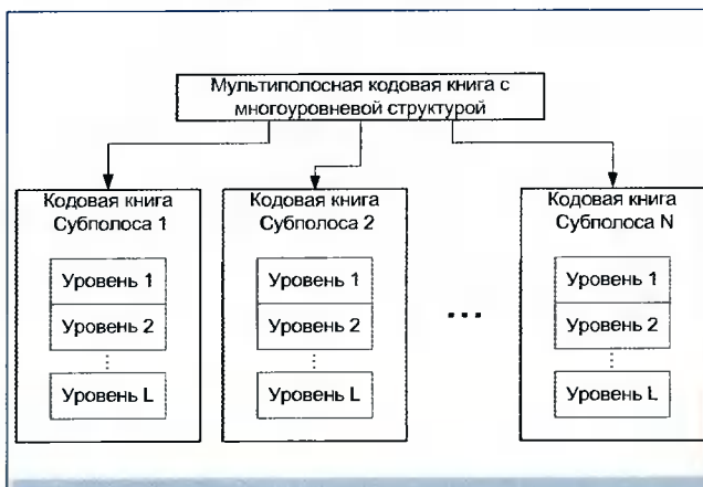
Рис. 5. Мультиполосная кодовая книга с многоуровневой структурой
