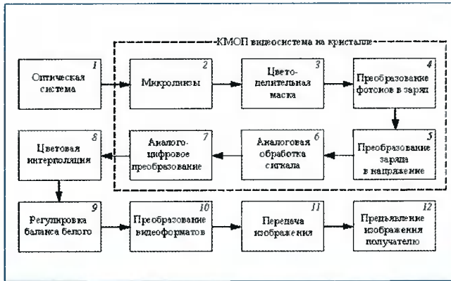
Рис. 1. «Видеосистема на кристалле» в типовой телевизионной системе.
